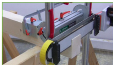
Přesné řezání – podél vedení řezu
