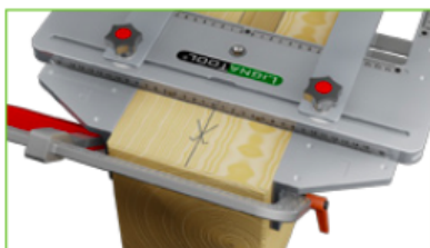
Stupnice šířky dřeva s upevněním
