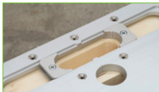
Detail šablony otvoru
