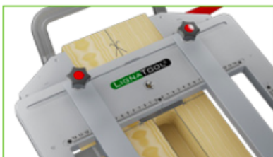
Stupnice šířky dlabu s ukazatelem frézovací hrany
